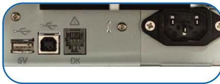
Transfert de données et charge USB de l'appareil par l'imprimante (max. de 2,4 A)
